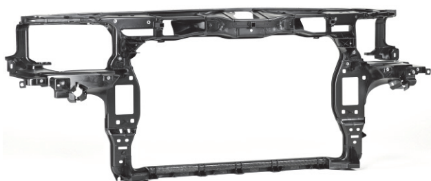
Figura 1 A barra inferior do front end exibe um perfil em forma de “U” feito de chapa de compósito de nylon
