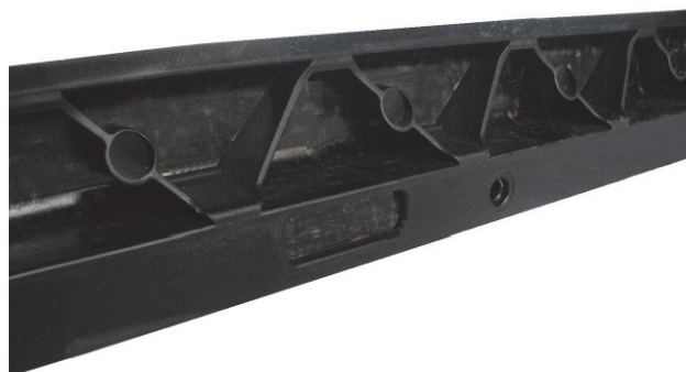
Figura 2 Detalhe do reforço inferior do front end com chapa de compósito de nylon
